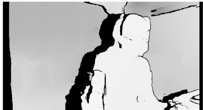
Figura 6. Reprojção e cálculo do mapa de profundidade de uma imagem estéreo.
